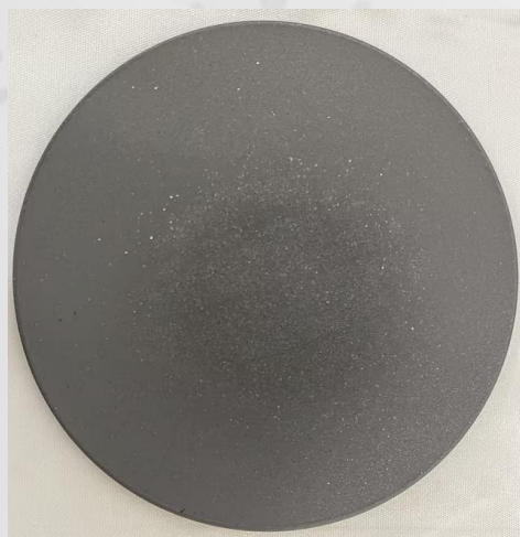
0.5mm金刚石在3寸 硅晶圆上
